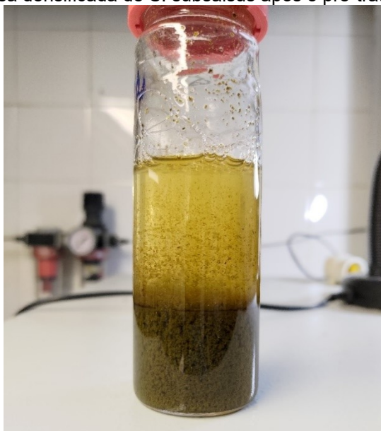
Figura 4.16: Biomassa densificada de S. subsalsus após o pré-tratamento termoquímico
